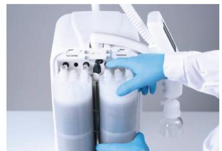
Autonomer Spezialist mit integrierter Vorbehandlungs- und Reinstwasserkartusche. Einfacher Kartuschenwechsel in Sekunden.
