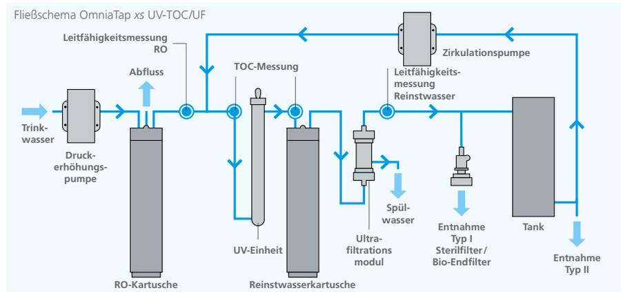
\* Für den Betrieb des OmniaTap xs<sup>touch</sup> ist ein externer Tank erforderlich, siehe Seite 13. Enthält bereits RO-Kartusche, Reinstwasserkartusche, Sterilfiltercapsule 0,2  $\mu\text{m}$ , sterilen Überlauf und Belüftungsfilter
